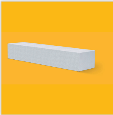
Xella, Nadproża Ytong (YN). Wykonane są ze zbrojonego betonu komórkowego, wysokość 24,9 cm. Maksymalna szerokość przekrywanego otworu wynosi 175 cm. Stosowane do otworów okiennych i drzwiowych. Zapewniają odpowiednią izolacyjność cieplną bez dodatkowego ocieplenia. Bardzo łatwe i szybko w zastosowaniu – montaż nadproża zajmuje dwóm osobom kilka minut.
