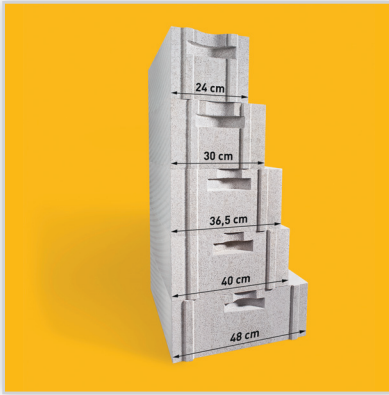
Xella, Bloczki Ytong Energy. Bloczki z betonu komórkowego. Zastosowanie: bloczki gr. 30; 36,5; 40; 48 cm – jednowarstwowe ściany konstrukcyjne, bloczki gr. 24 cm – ciepła ściana dwuwarstwowa.
